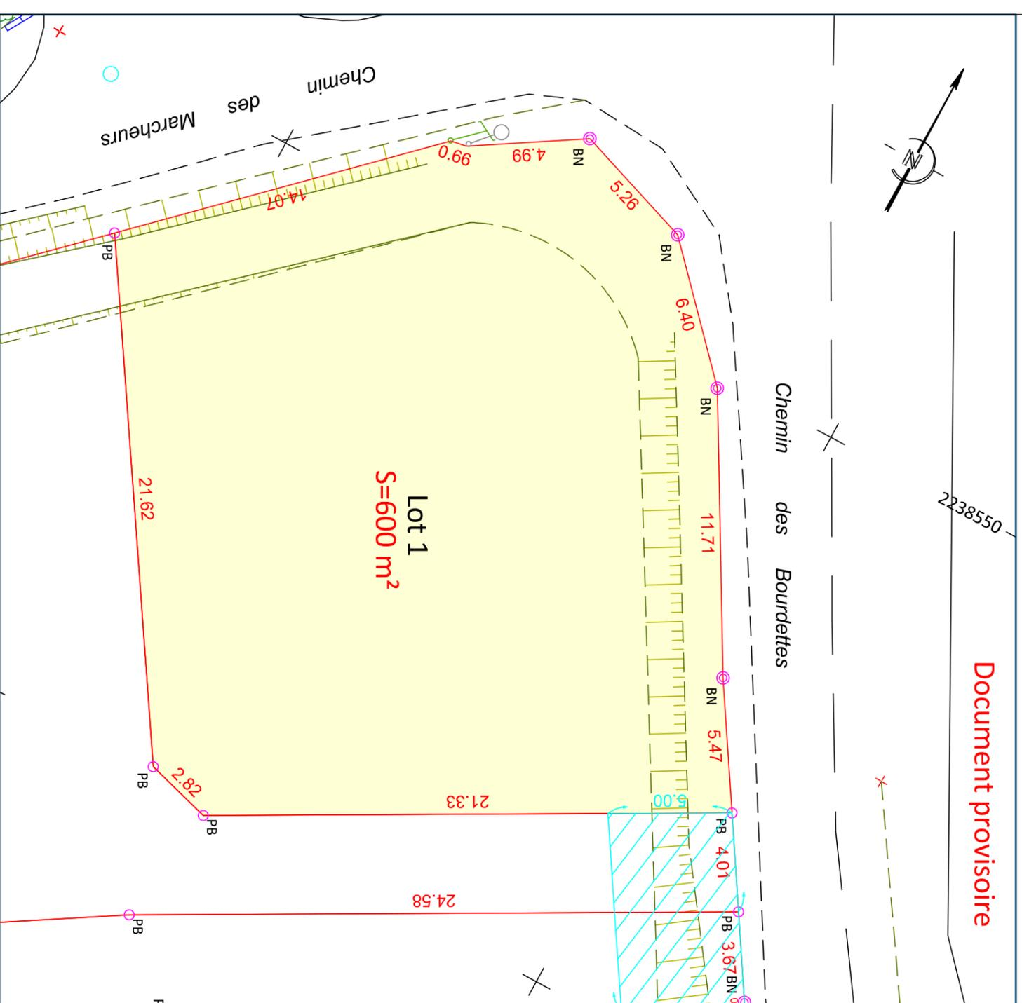
Coordonnées rattachées au système RGF 93 et projection CC43
